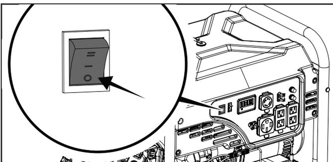
4. Si la génératrice a été démarrée électriquement, poussez l'interrupteur de batterie à la position « ARRÊT ».
