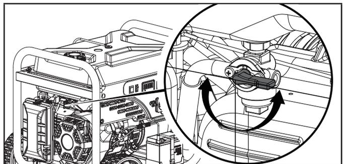
**Important :** Assurez-vous toujours que le robinet d'essence est « FERMÉ », l'interrupteur de démarrage et l'interrupteur de batterie sont en position « ARRÊT » lorsque la génératrice n'est pas utilisée.
