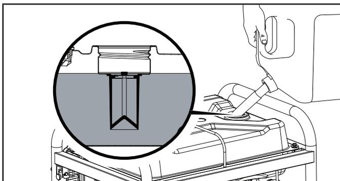
3. Le niveau de carburant approximatif est indiqué sur la jauge à carburant située en haut du réservoir.
