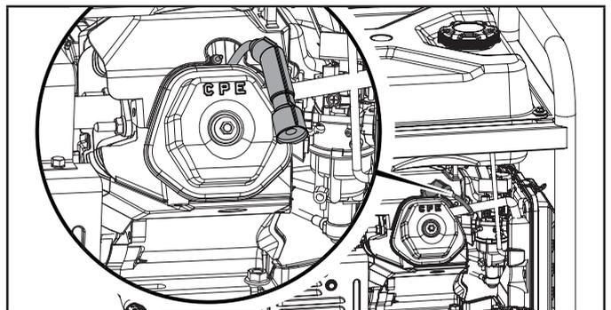
3. Inspectez l'électrode de la bougie. Elle doit être propre et sans usure afin de produire l'étincelle requise au démarrage.
