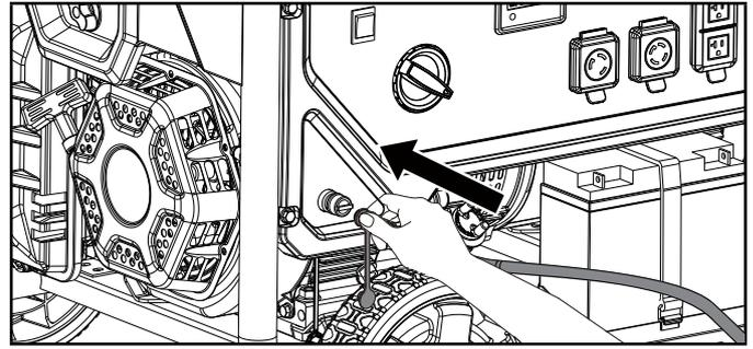
4. Conecte el otro extremo de la manguera de GLP a la válvula del cilindro de GLP y apriete a mano.
