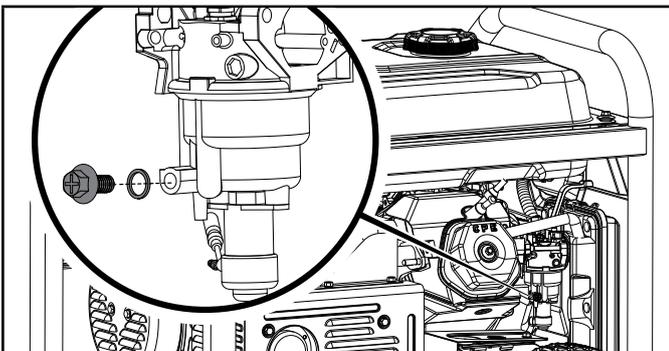
7. Cuando la gasolina pare de fluir del carburador, reemplace y apriete el perno de drenaje del carburador y asegúrese de deshacerse de la gasolina drenada en acuerdo con las regulaciones y normas locales.
