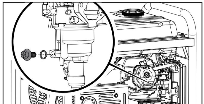
4. Cuando la gasolina pare de fluir del carburador, reemplace y apriete el perno de drenaje del carburador y asegúrese de deshacerse de la gasolina drenada en acuerdo con las regulaciones y normas locales.
