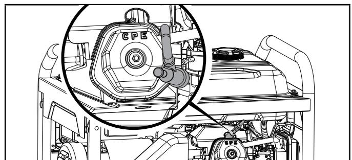
3. Revise el electrodo en la bujía. Debe estar limpio y no desgastado para producir la chispa de encendido.
