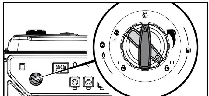
4. Si opera en GLP, cierre la válvula en el cilindro de GLP. Si opera en GN, cierre la válvula de suministro de GN.
