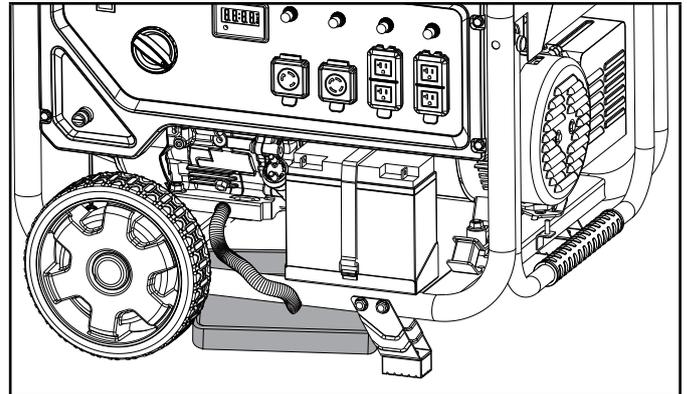
3. Apunte la manguera a una bandeja de drenaje y deje que el aceite drene por completo. NOTA: El extremo de la manguera debe ser inferior a la base del motor para permitir que el aceite drene.
