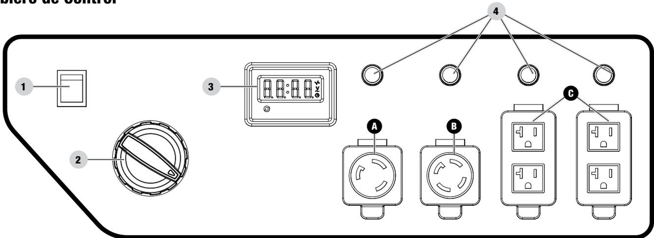
1. **Interruptor de arranque** – Se utiliza para encender de forma eléctrica el generador.
