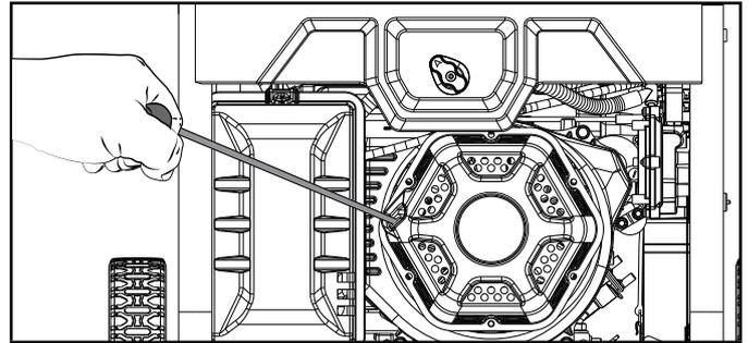
5. Tan pronto como arranque el motor, gire el dial EZ Start a la posición "CORRER GASOLINA" por una duración de 2-5 segundos.
