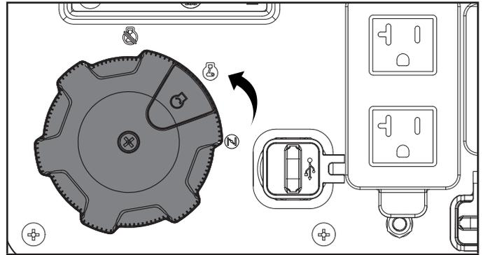
Arranque del motor en caliente:
