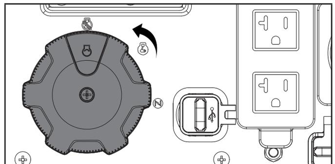
**Importante:** Siempre asegúrese de que el dial EZ Start esté siempre en posición "APAGADO" cuando el generador no esté en funcionamiento.
