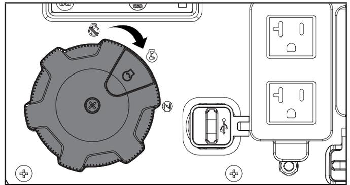
4. Pulse y mantenga pulsado el interruptor de arranque amarillo del dial EZ Start hacia el centro del dial. Suelte cuando el motor comience a arrancar. Si el motor no arranca dentro de cinco segundos, suelte el interruptor y espere al menos diez segundos antes de intentar arrancar el motor de nuevo.
