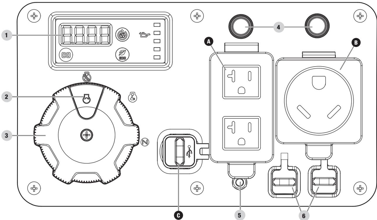
1. **Intelligauge con medidor de potencia y CO Shield®** – Vea la sección *Intelligauge*.
