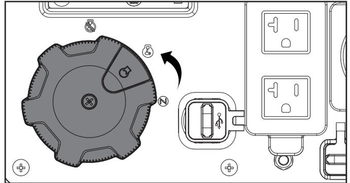
7. Pulse y mantenga pulsado el interruptor de encendido de color amarillo en el EZ Dial de inicio hacia el centro de la esfera de hasta 5 segundos o hasta que empezó.
