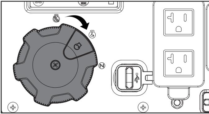
5. Pulse y mantenga pulsado el interruptor de arranque amarillo del dial EZ Start hacia el centro del dial. Suelte cuando el motor comience a arrancar. Si el motor no arranca dentro de cinco segundos, suelte el interruptor y espere al menos diez segundos antes de intentar arrancar el motor de nuevo.
