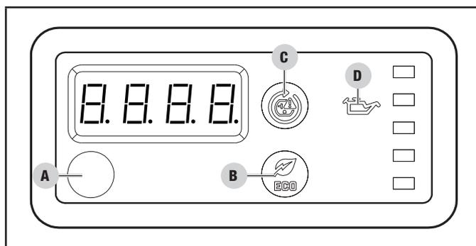
C. **Bouton de réinitialisation de surcharge CA** – Utilisé pour remettre les prises sous tension après une surcharge.
