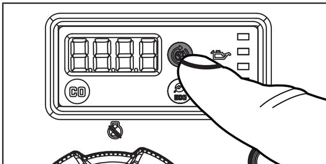
La vitesse normale du moteur sera rétablie lors que des charges électriques seront branchées. Le moteur tourne continuellement à la vitesse normale si l'interrupteur du mode économique n'est pas activé.
