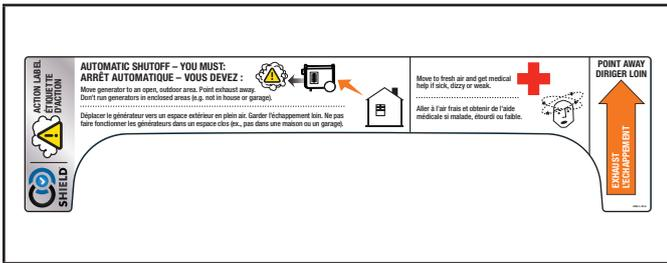
Lorsque vous vous approchez de la génératrice pour chercher la cause de l'arrêt automatique, un témoin à DEL **rouge** clignotant dans la zone du dispositif CO Shield® vous indiquera que l'arrêt automatique de la génératrice a été causé par l'accumulation risquée de CO. Le témoin à DEL rouge clignotera pendant au moins cinq (5) minutes après l'arrêt automatique.
