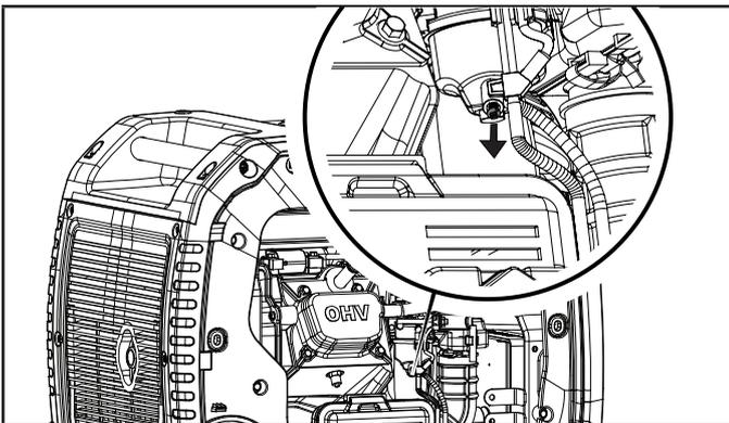
6. Lorsque le carburant ne circule plus dans la tubulure transparente, serrez fermement la vis de vidange en la tournant dans le sens des aiguilles d'une montre. Jetez l'essence vidangée conformément aux règlements et directives locales.
