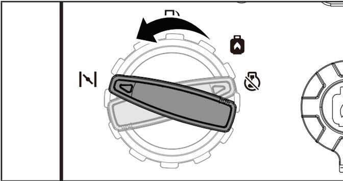
5. Retire la tapa de mantenimiento del lado de drenaje del aceite en el lado derecho del tablero de control empujando y girando los dos sujetadores en sentido contrario a las agujas del reloj hasta la posición horizontal desbloqueada.
