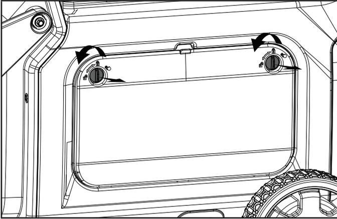
3. Retire la tapa de la ranura de drenaje de aceite y jale la manguera de drenaje a través de la ranura.
