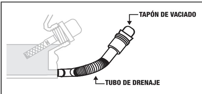
5. Asegure que la manguera de drenaje de aceite este mas abajo que el motor y permita que el aceite se drene completamente en un recipiente apropiado.
