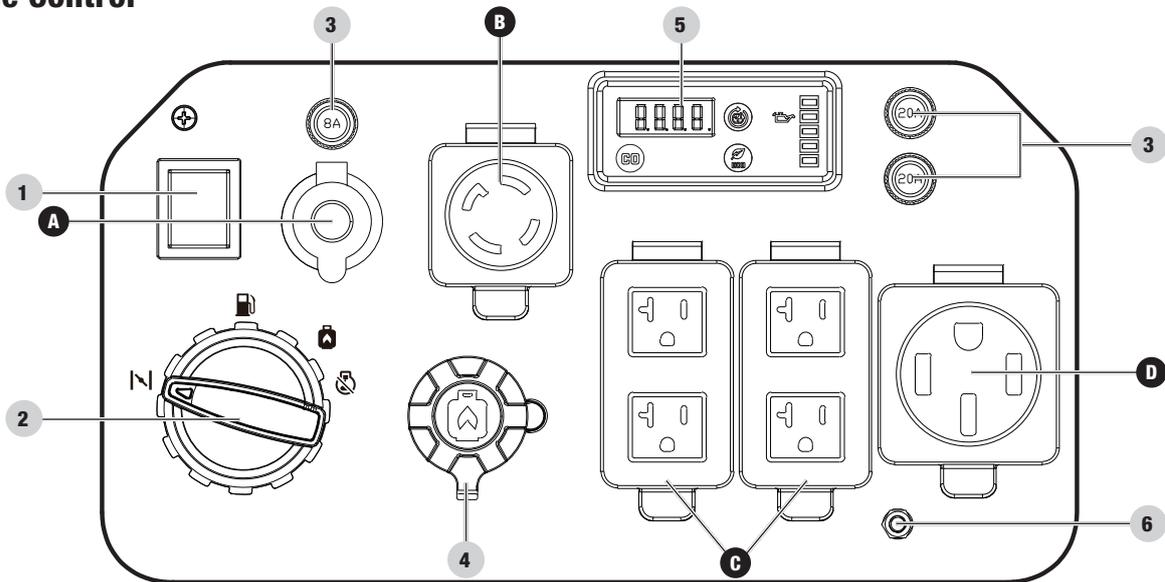
1. **Interruptor de arranque** – Se utiliza para ENCENDER el generador.
