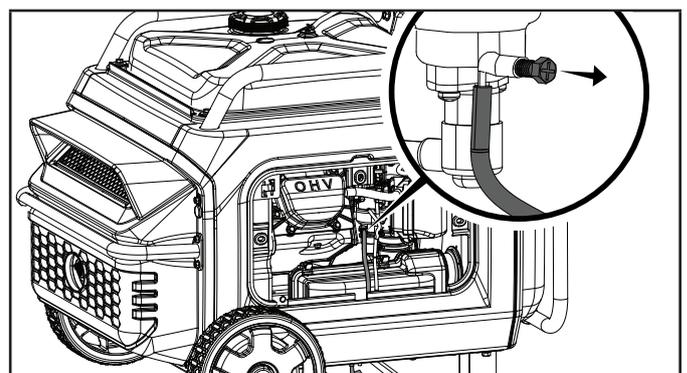
6. Cuando la gasolina pare de fluir del tubo transparente, gire el tornillo de drenaje a reloj (derecha) hasta que se apriete. Deshágase de la gasolina drenada en acuerdo con las regulaciones y normas locales.
