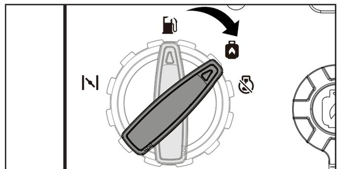
4. Después que se detenga el motor, gire el dial EZ Start a la posición “MOTOR APAGADO”.
