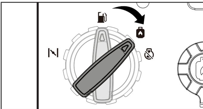
6. Después de que se haya agotado el combustible y el motor se haya apagado, gire el dial EZ Start al la posición "MOTOR APAGADO" y permita que se enfríe el motor.
