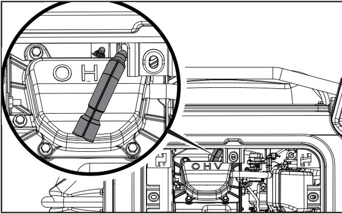
3. Use una herramienta para bujías (incluida), o un dado de 13/16 in. (21 mm) (no incluido) para remover la bujía.
