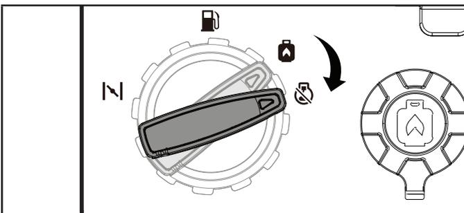
**Importante:** Siempre asegúrese de que el dial EZ Start esté siempre en posición "MOTOR APAGADO" cuando el generador no esté en funcionamiento.
