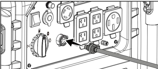
7. Revise todas las conexiones en busca de fugas mojando las conexiones con una solución de agua y jabón. Burbujas que aparecen o las burbujas que crecen indican que existe una fuga. Si existe una fuga en una conexión, cierre la válvula en el tanque y apriete la conexión. Gire para abrir la válvula de nuevo y vuelva a comprobar la conexión con el jabón y agua. Si la fuga continúa o si la fuga no está en una conexión, entonces no use el generador y contacte al servicio al cliente.
