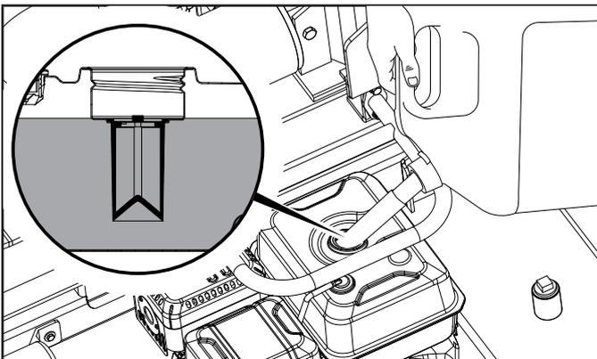
3. El nivel aproximado de combustible se demuestra en el medidor de combustible en la parte de arriba del tanque.
