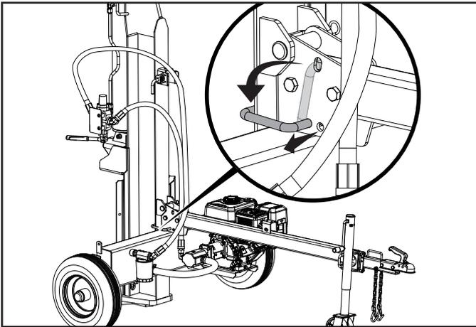
4. Para cambiar de orientación vertical a horizontal, invierta los pasos. El viga se bloqueará automáticamente en el seguro automático en la barra de remolque cuando se baje a su posición.
