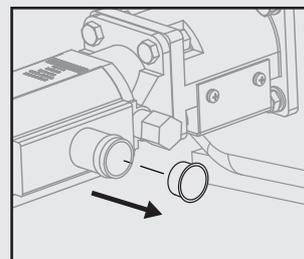
La bomba hidráulica puede contener residuo de aceite de los procedimientos de pruebas durante la producción. Recomendamos que use una bandeja para aceite debajo de la bomba antes de remover los tapones de envío.
