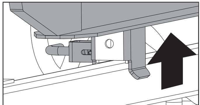
3. Extraiga el pasador de seguro rápido cargado por resorte y gírelo alrededor de la posición de las 9 en punto alrededor del borde en la viga para asegurarlo en la posición vertical.
