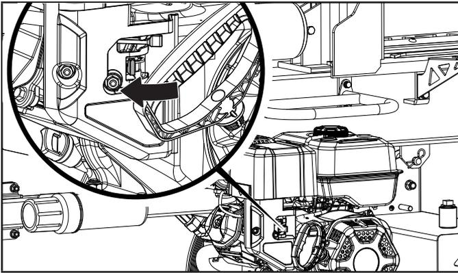
2. Deje el motor en marcha hasta que la falta de combustible haya detenido el motor. Esto usualmente toma unos minutos.
