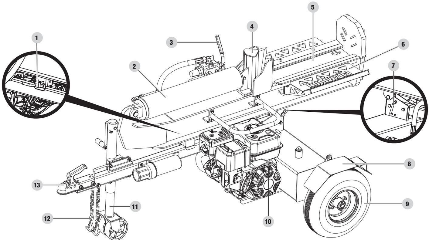
1. **Seguro automático horizontal de la viga** – Asegura la viga en posición horizontal.
