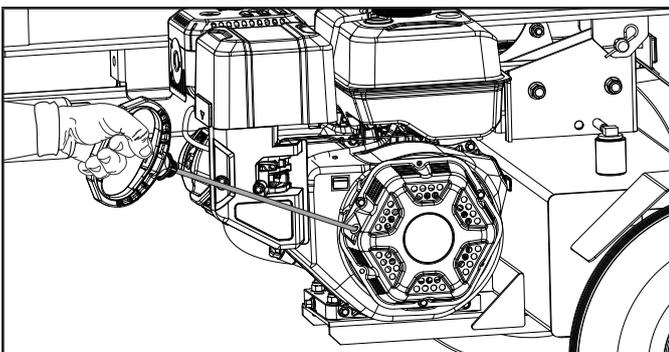
5. A medida que el motor se calienta, mueva la palanca del ahogador a la posición "CORRER".
