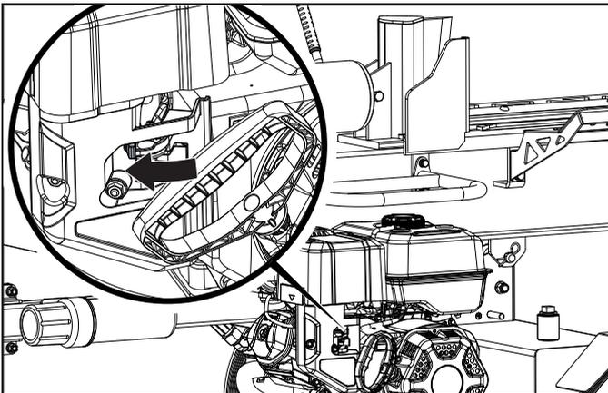
4. Tire del cable de arranque hasta que se sienta la resistencia y luego tire rápidamente.
