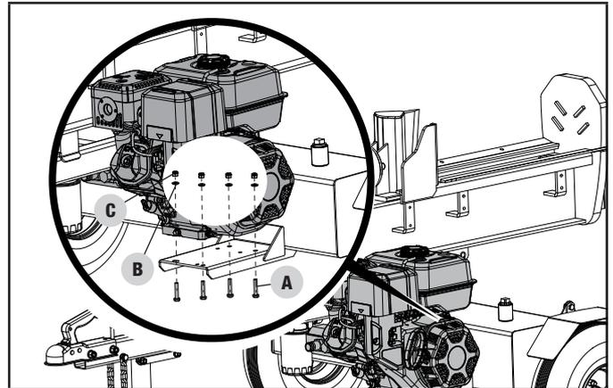
2. Instale un perno M10 × 45 (A) a través del orificio de la plataforma del motor y a través del orificio de la base del motor.
