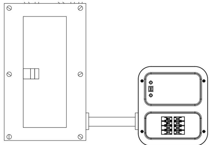
1. Retirer le couvercle avant du boîtier du CTM en enlevant (4) quatre vis et en débranchant les (3) trois connecteurs du faisceau de câbles fixés au couvercle.
