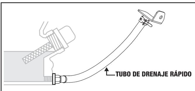
5. Apunte la manguera a una bandeja de drenaje y deje que el aceite drene por completo. NOTA: El extremo de la manguera debe ser inferior a la base del motor para permitir que el aceite drene.
