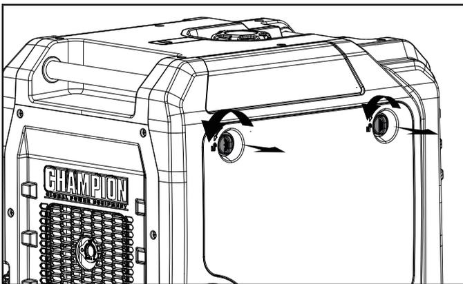
2. Localice la cubierta de plástico del filtro de aire y retírela girando el sujetador en sentido contrario a las agujas del reloj y tire de la cubierta.
