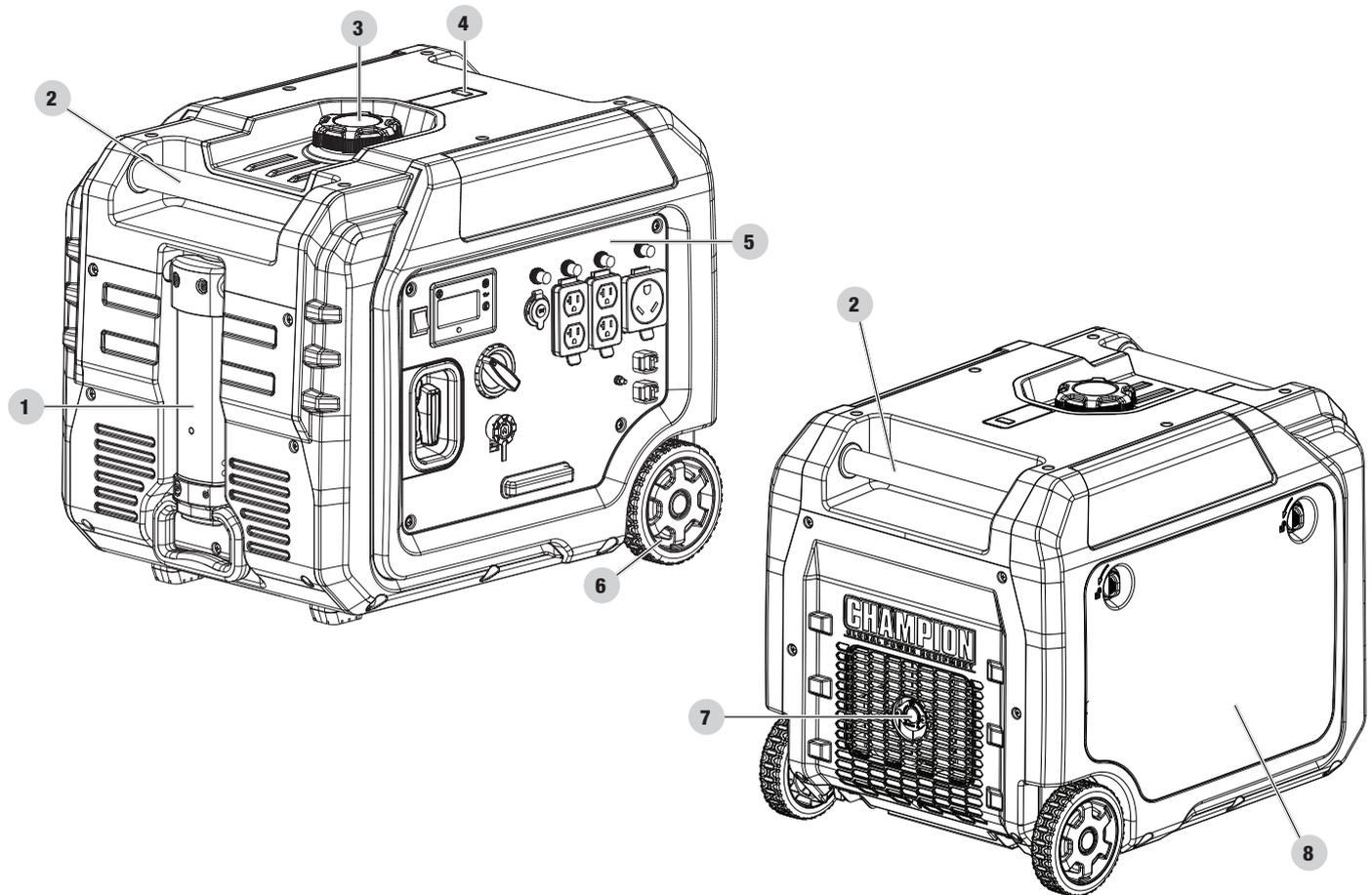
1. **Mango abatible** – Mango extensible utilizado para mover la unidad al levantar y andar en las ruedas. No lo utilice para levantar o cargar la unidad.
