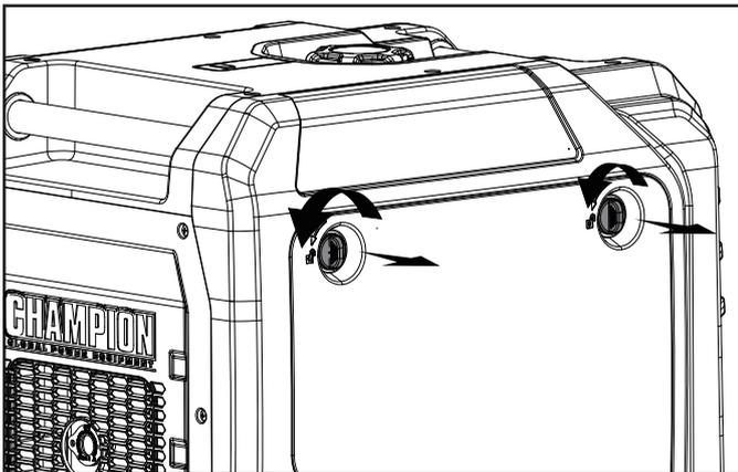
3. Retire la tapa de llenado/varilla de medición de aceite para agregar el aceite.
