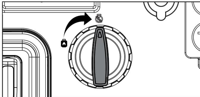
**Importante:** Siempre asegúrese de que el dial EZ Start el esté siempre en posición "APAGADO" cuando el generador no esté en funcionamiento.
