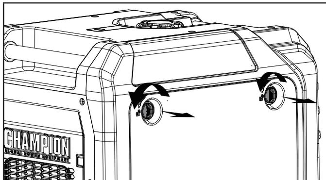
2. Retire la cubierta del conector y oprima las dos mitades del conector de la batería firmemente.
