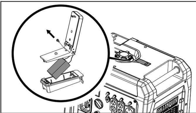
4. Retire la batería de los conectores de la batería y sustitúyala por la nueva batería de 9V.
