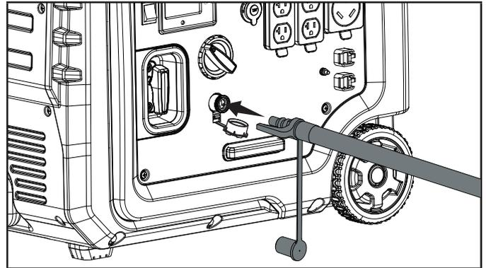
7. Revise todas las conexiones en busca de fugas mojando las conexiones con una solución de agua y jabón. Burbujas que aparecen o las burbujas que crecen indican que existe una fuga. Si existe una fuga en una conexión, cierre la válvula en el tanque y apriete la conexión. Gire para abrir la válvula de nuevo y vuelva a comprobar la conexión con el jabón y agua. Si la fuga continúa o si la fuga no está en una conexión, entonces no use el generador y contacte al servicio al cliente.
