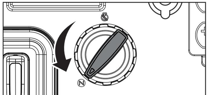
2. Oprima y mantenga oprimido el interruptor de arranque a la posición "ARRANCAR" por 2-3 segundos.
