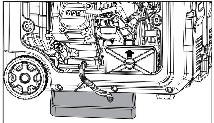
6. Vuelva a colocar la manguera de drenaje de aceite en el soporte del enchufe y deslice la abrazadera del muelle en su posición.
