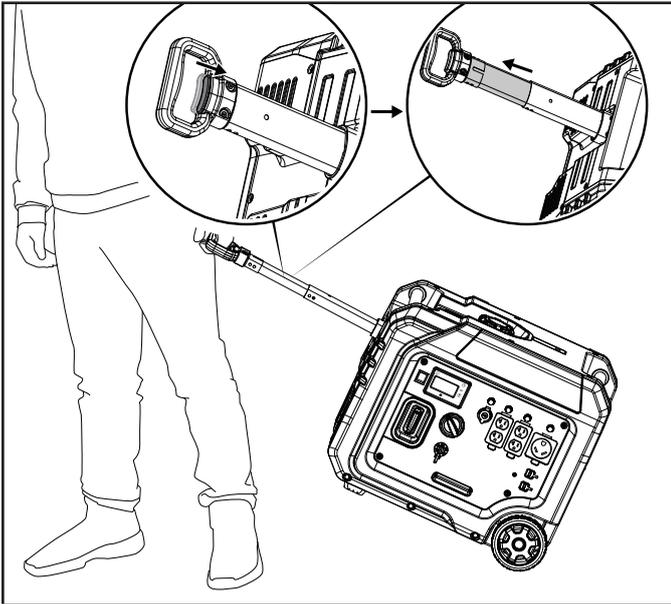
3. Usando el mango, incline el extremo del generador un poco del suelo hasta que esté equilibrado en las ruedas.
