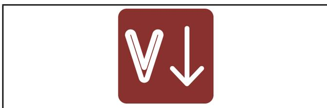
L'icône ROUGE s'allume si la puissance de sortie de la génératrice est inférieure aux limites prédéfinies.
