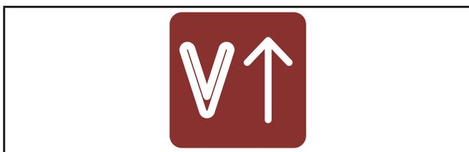
L'icône ROUGE s'allume si la puissance de sortie de la génératrice dépasse les limites prédéfinies de 257 VCA.
