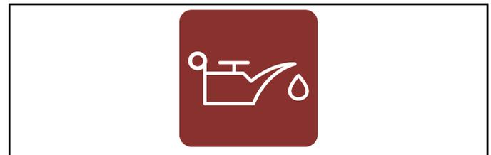
L'icône ROUGE s'allumera lorsque la pression d'huile moteur descend en dessous d'un niveau de fonctionnement sûr. Lorsque ce défaut est détecté, la génératrice s'arrête et le redémarrage est désactivé. L'icône ROUGE sur le module de l'appareil de contrôle et la DEL extérieure seront allumées.
