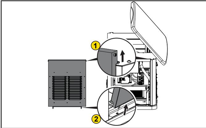
– **Reemplazo del panel derecho:** Con la cubierta superior abierta, reemplace el panel lateral ubicando los pasadores del panel en la base, incline la cubierta hacia adelante y, luego, deslícela hacia abajo con los pasadores superiores en su lugar. Baje la cubierta superior y trabé.
