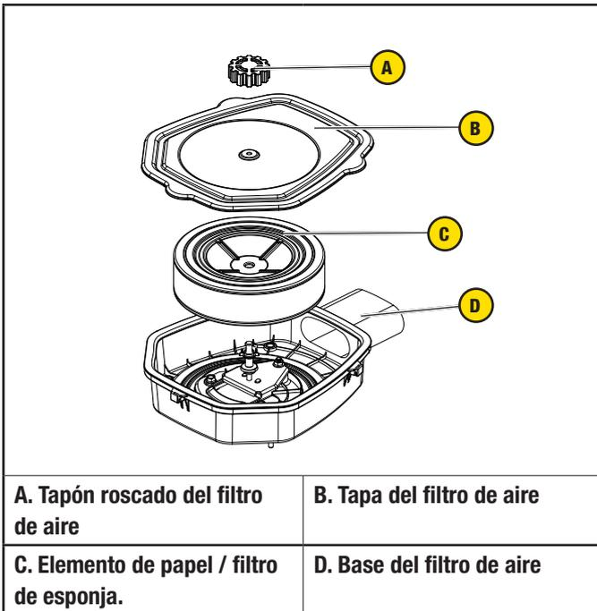
7. Retire el elemento de papel / filtro de esponja (C) e inspeccione el elemento de papel para ver si hay rasgaduras o roturas. Reemplácelo si está dañado.
