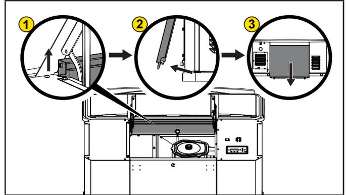
– **Reemplazo del panel trasero:** Con la cubierta superior abierta, desde la parte posterior, levante el panel trasero por debajo de la tapa de la cubierta e inserte los pasadores de los paneles en la base. Desde la parte frontal, tire del panel hacia arriba y, a continuación, deslícelo hacia abajo con los pasadores superiores en su lugar.
