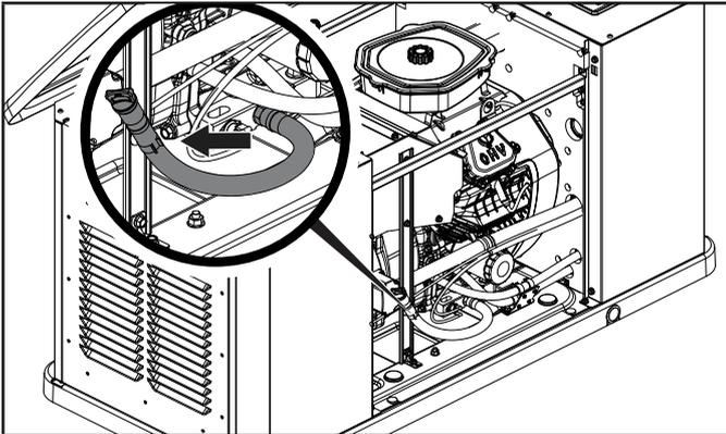
11. Utilizando un embudo, llene el motor con la cantidad adecuada de aceite para motor. **NO LLENE EN EXCESO.**
