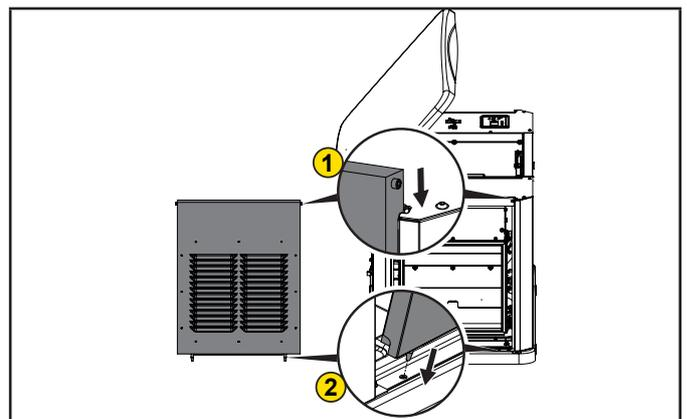
– **Extracción del panel derecho:** Con la cubierta superior abierta, levante y retire cada panel lateral.
