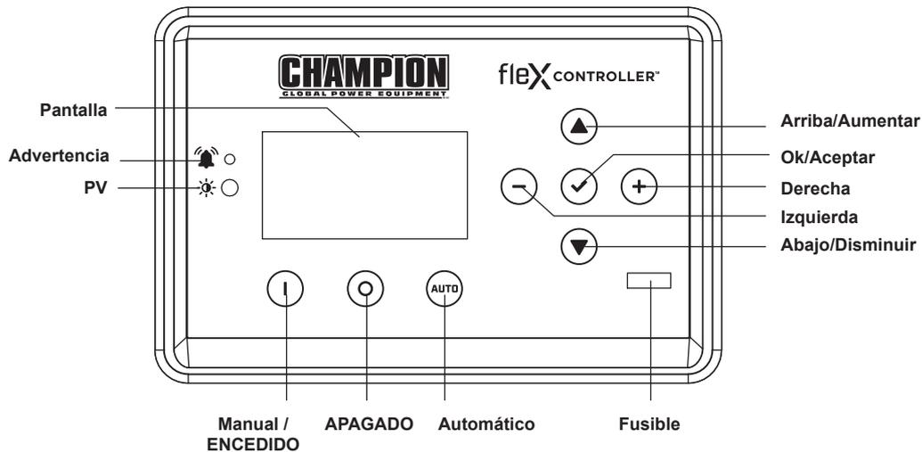
El fleX Controller™ proporciona monitorización en tiempo real, protección, información sobre el estado y ajustes del generador doméstico de reserva (HSB).
