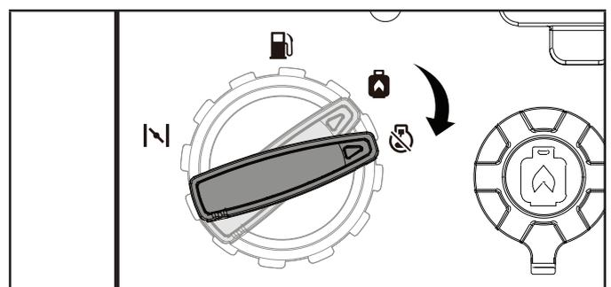
**Important :** Assurez-vous toujours que le cadran EZ Start est en position « ARRÊT » lorsque la génératrice n'est pas utilisée.
