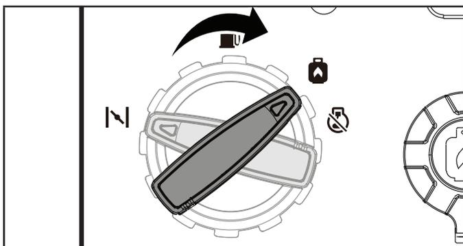
7. Appuyez et maintenez le commutateur d'allumage à la position « DÉMARRAGE » pendant 5 secondes ou jusqu'au démarrage.
