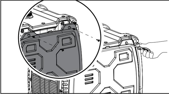
2. Localice la tapa de plástico del filtro de aire y retírela pellizcando los clips y tirando de la tapa.
