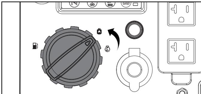
4. Permita que el generador corra hasta que el motor se detenga completamente de la falta de combustible.
