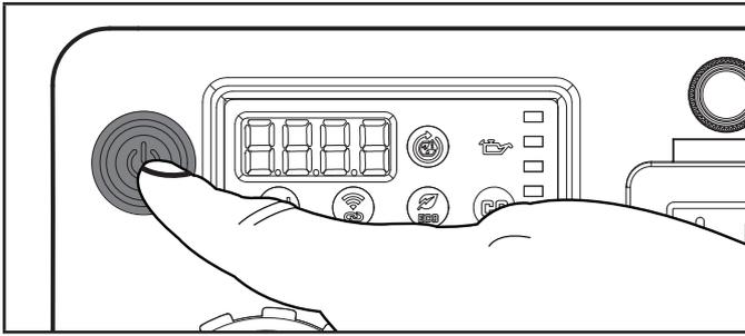
6. Oprima el botón de control de encendido una vez para arrancar el motor. Si el motor no arranca, espere al menos diez segundos antes de intentar arrancar el motor de nuevo.
