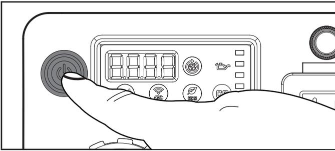
4. Oprima el botón de control de encendido una vez para arrancar el motor. Si el motor no arranca, espere al menos diez segundos antes de intentar arrancar el motor de nuevo.
