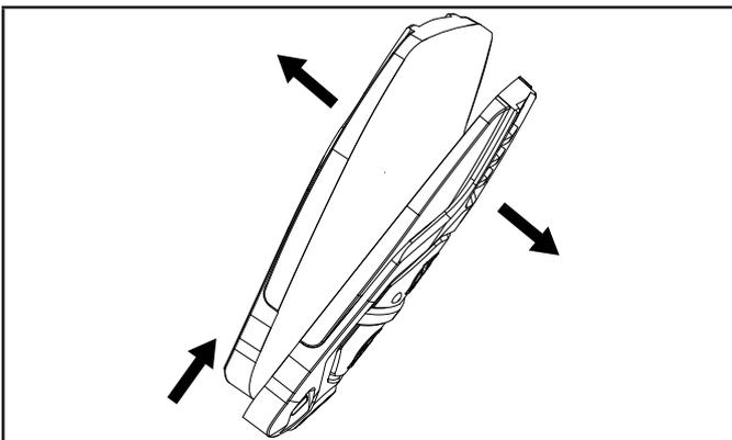
5. Retire con cuidado la placa de circuito para localizar y reemplazar las pila CR2016.
