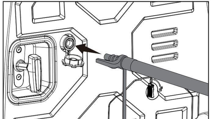
7. Revise todas las conexiones en busca de fugas mojando las conexiones con una solución de agua y jabón. Burbujas que aparecen o las burbujas que crecen indican que existe una fuga. Si existe una fuga en una conexión, cierre la válvula en el tanque y apriete la conexión. Gire para abrir la válvula de nuevo y vuelva a comprobar la conexión con el jabón y agua. Si la fuga continúa o si la fuga no está en una conexión, entonces no use el generador y contacte al servicio al cliente.
