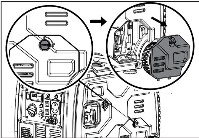
3. Retire la tapa de llenado/varilla de medición de aceite para agregar el aceite.
