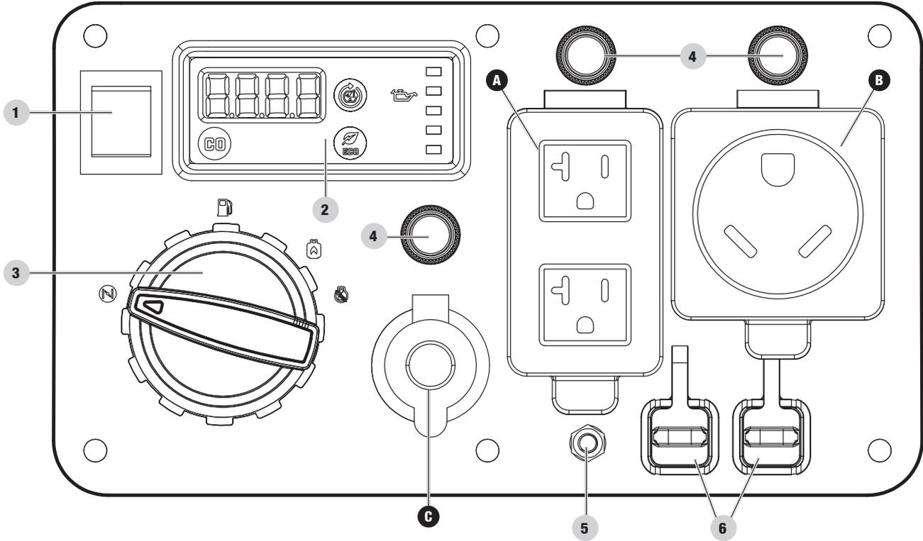
1. **Interruptor de arranque** – Se utiliza para ENCENDER el generador.
