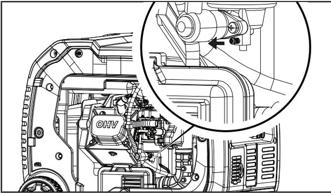
6. Cuando la gasolina pare de fluir del tubo transparente, gire el tornillo de drenaje a reloj (derecha) hasta que se apriete. Deshágase de la gasolina drenada en acuerdo con las regulaciones y normas locales.
