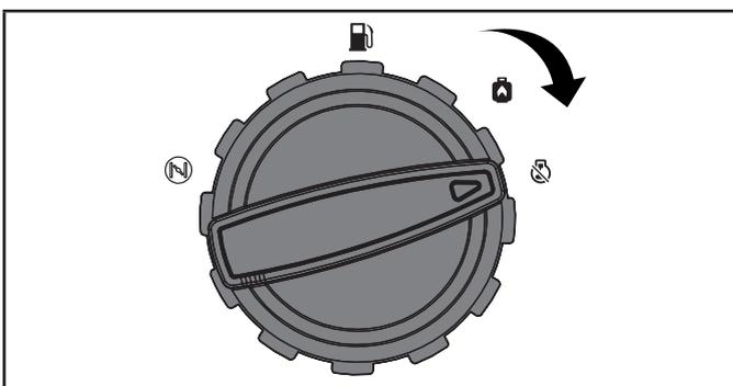
**Importante:** Siempre asegúrese de que el dial EZ Start siempre este en posición "APAGADO" cuando el generador no esté en funcionamiento.
