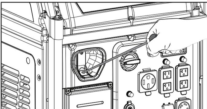
10. Si el motor falla en arrancar con un jalón y con el ahogador en la posición "CORRER," entonces mueva el ahogador en la posición "AHOGAR" y repita el paso Jale-Para-Cebar.
