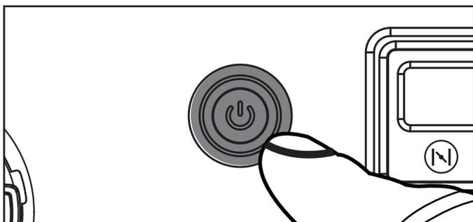
5. Pulse el botón de control del encendido una vez para arrancar el motor. Si el motor no arranca, espere al menos diez segundos antes de intentar arrancarlo de nuevo.
