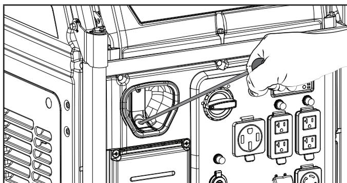
6. No ahogar en exceso. En cuanto arranque el motor, coloque el ahogador en la posición "CORRER" (izquierda).
