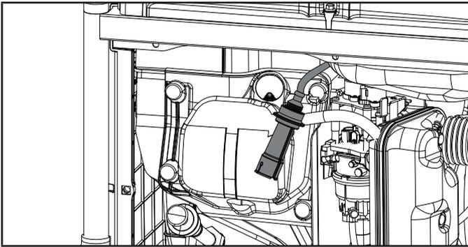
3. Use una herramienta para bujías (incluida), o un dado de 13/16 in. (21 mm) (incluido) para remover la bujía.
