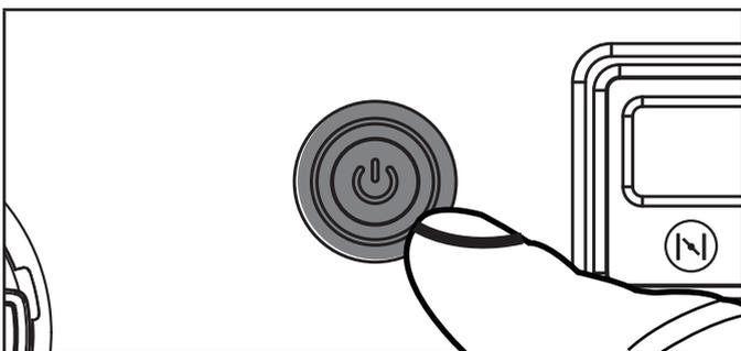
3. Pulse el botón de control del encendido una vez para arrancar el motor. Si el motor no arranca, espere al menos diez segundos antes de intentar arrancarlo de nuevo.
