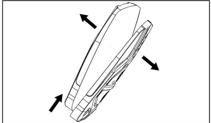
5. Retire con cuidado la placa de circuito para localizar y reemplazar las pila CR2016.
