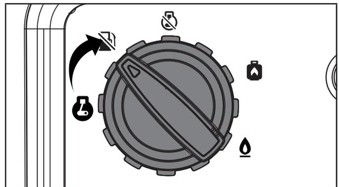
4. Permita que el generador corra hasta que el motor se detenga completamente de la falta de combustible.
