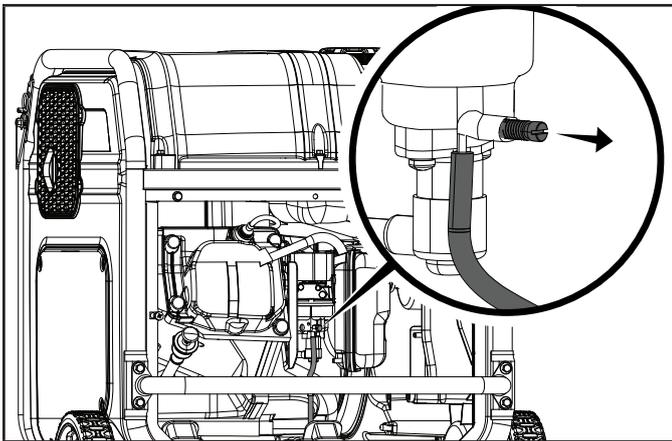
5. Cuando la gasolina deje de fluir, gire el tornillo de vaciado en el sentido de las agujas del reloj hasta que quede apretado. Elimine correctamente la gasolina drenada de acuerdo con las normativas o directrices locales.
