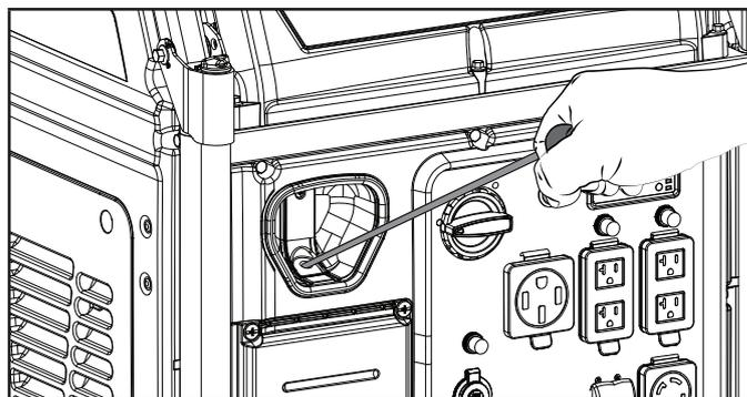
9. Si el motor falla en arrancar con un jalón y con el ahogador en la posición "CORRER," entonces mueva el ahogador en la posición "AHOGAR" y repita el paso Jale-Para-Cebar.
