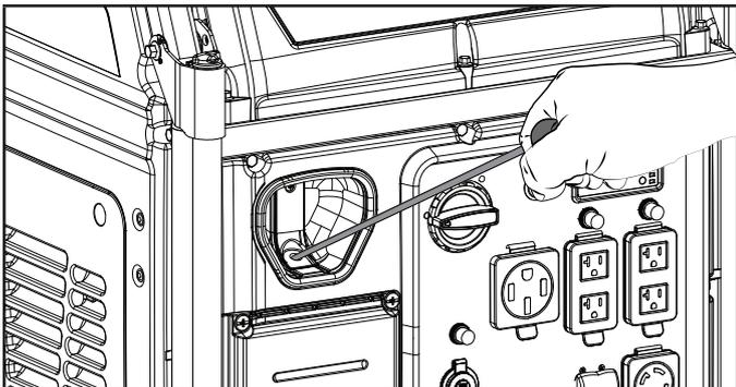
6. No estrangule en exceso. En cuanto arranque el motor, pulse una vez el botón del ahogador para ponerlo en la posición "CORRER". El botón del ahogador ya no se iluminará cuando esté en la posición "CORRER".
