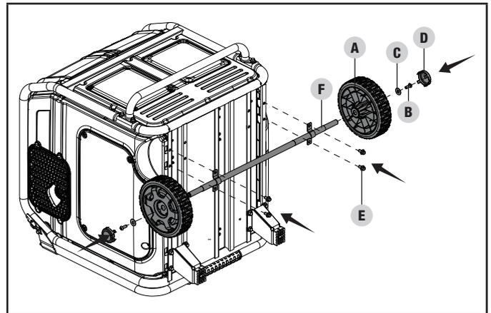
6. Vuelva a inclinar lentamente el generador para que descansa sobre las ruedas y la pata de apoyo.
