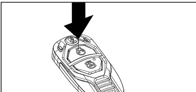
6. Oprima y mantenga oprimido el botón de ajuste inalámbrico aproximadamente tres segundos hasta que el botón azul del LED botón de ajuste inalámbrico se apague.
