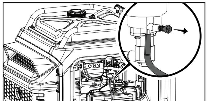
6. Cuando la gasolina pare de fluir del tubo transparente, gire el tornillo de drenaje a reloj (derecha) hasta que se apriete. Deshágase de la gasolina drenada en acuerdo con las regulaciones y normas locales.
