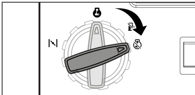
**Importante:** Siempre asegúrese de que el dial EZ Start estén siempre en posición "APAGADO" cuando el generador no esté en funcionamiento.
