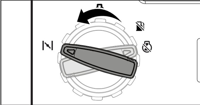
3. Retire la tapa lateral de aceite empujando y girando los dos sujetadores en sentido contrario a las agujas del reloj hasta la posición horizontal desbloqueada.
