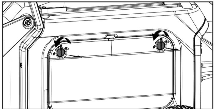
3. Retire la tapa de llenado/varilla de medición de aceite para agregar el aceite.
