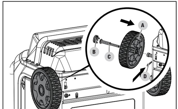
6. De vuelta al generador al otro costado y repita los pasos anteriores para fijar la segunda rueda.
