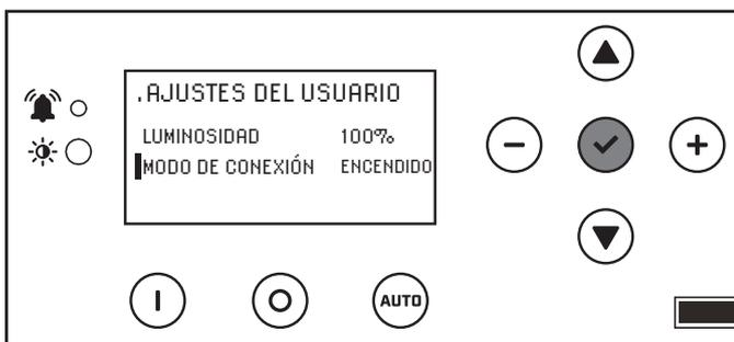
5. Después de ajustar MODO DE CONEXIÓN, el fleX Controller™ saldrá y cambiará a APAGADO.
