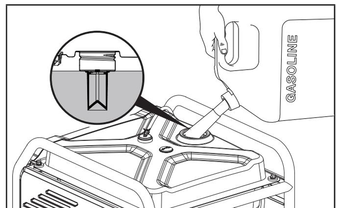
3. El nivel de combustible aproximado se muestra en el medidor de combustible en la parte superior del tanque de combustible.
