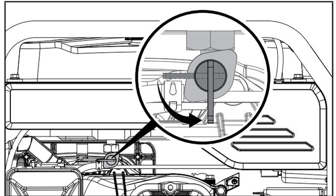
4. Oprima el interruptor del motor a la posición "ENCENDIDO".
