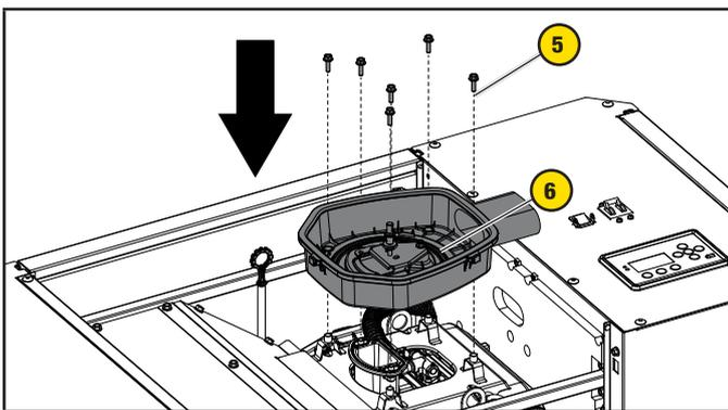
15. Installez l'élément en papier et l'élément en mousse du filtre à air en un seul morceau dans la base du filtre à air.
