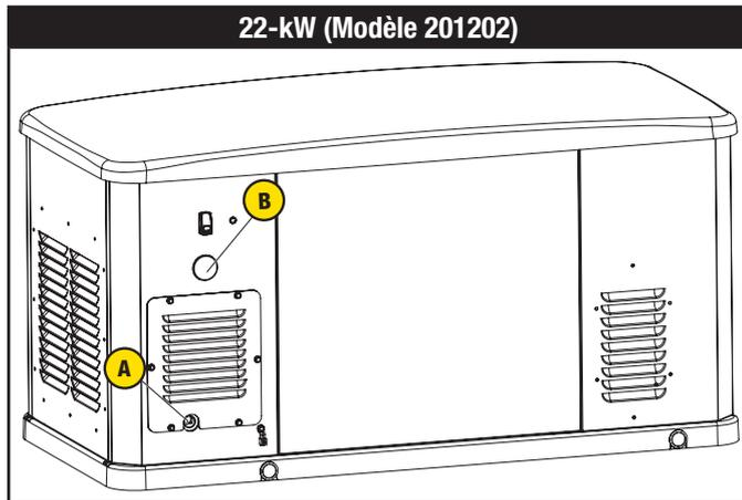
Deux (2) longueurs de 1,5 m (5 po.) de tube en acier de 2,5 cm (1 po.) (fourni par l'installateur) sont nécessaires pour soulever la génératrice. Insérez les tubes en acier dans les trous de levage situés près de la base de la génératrice dans le socle en composite, à chaque extrémité.
