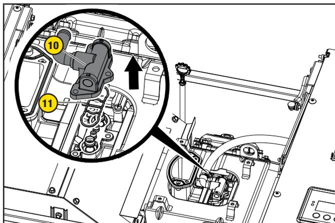
11. Installez l'assemblage du mélangeur principal (10) avec le point vert (qui indique le GPL) sur le corps du mélangeur. Assurez-vous que le joint d'étanchéité (11) est installé du côté de la chambre d'admission du carburant.
