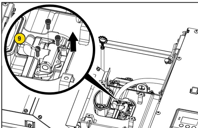
10. Retirez l'assemblage du mélangeur principal (10) ainsi que le joint d'étanchéité (11).
