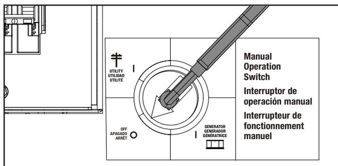
4. Réactivez le courant électrique vers l'ATS.
