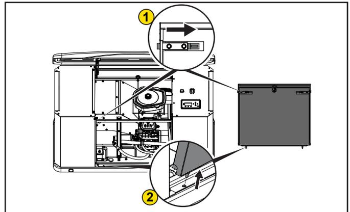
2. Enlevez le capuchon de la bague et installez la rondelle et le boulon, comme il est illustré. Le boulon et la rondelle se serrent à l'intérieur de la bague anti-ouragan sous le carter de la génératrice de secours domestique. Serrez au couple de 3,2 Nm (2,4 lb-pi) ou serrez à la main et tournez encore à 1/8.
