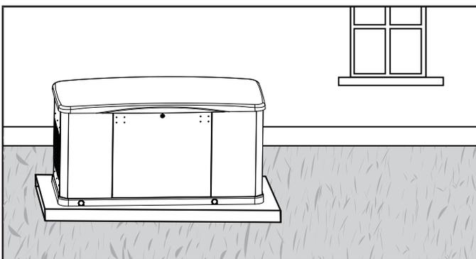
Tassez le remplissage pour fournir une base solide à la génératrice. N'oubliez pas que le niveau final des pierres doit être 5,1 à 7,6 cm (2 ou 3 po) au-dessus du niveau du sol d'origine afin d'assurer l'écoulement et le drainage de l'eau.
