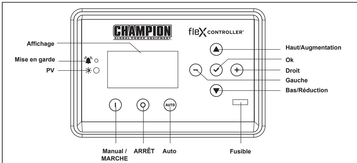
Le module fleX Controller™ assure en temps réel la surveillance, la protection, l'information sur l'état et les paramètres de la HSB.
