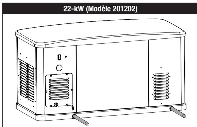
Vous pouvez également soulever la génératrice à l'aide d'une sangle, d'un dispositif de levage, d'un crochet et d'un palan correctement calibrés, fixés aux deux tubes de levage en acier, à condition d'utiliser des barres de répartition pour garantir que les courroies, chaînes ou câbles NE touchent PAS la génératrice.
